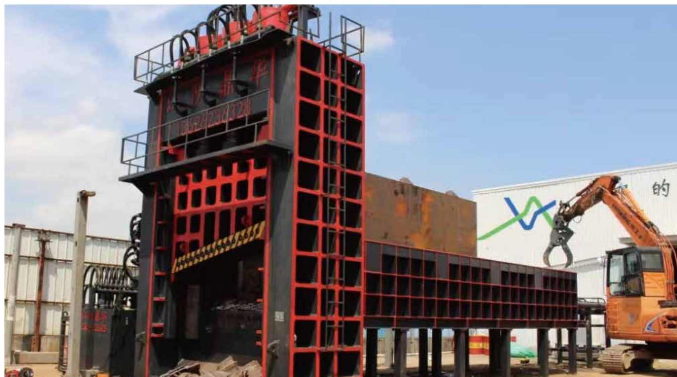
中国·上海 2000吨龙门剪现场 CHINA · SHANGHAI 2000 TONS GANTRY CUTTING SITE
